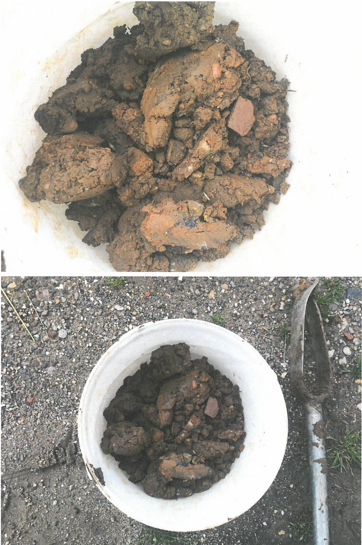
Bilder 15 und 16: Eimermischprobe MP4 A (HB) aus den am 01.07.2021 mittels Edelmann-Bohrer im „hinteren“ Untersuchungsbereich oberflächennah entnommenen Einzelproben
