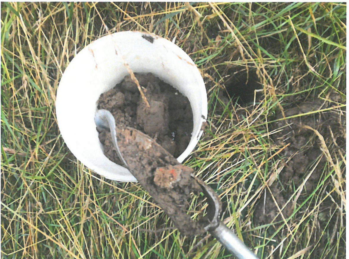
Bilder 11 und 12: Einzelproben (Auszug) der am 01.07.2021 mittels Edelmann-Bohrer entnommenen Bodenmischprobe MP4 A (HB)
