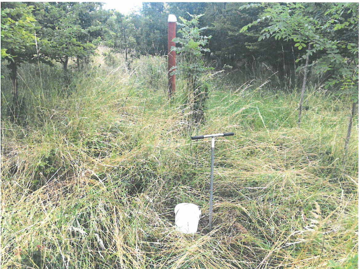
Bilder 9 und 10: Entnahme von oberflächennahen Bodenproben aus der hinteren/nordöstlichen Hälfte des Untersuchungsbereichs (= spätere Freifläche, siehe auch Anlage 1.2.4) am 01.07.2021 (Probengewinnung mit dem Edelmann-Bohrer bis max. t = 0,5 m u. GOK)
