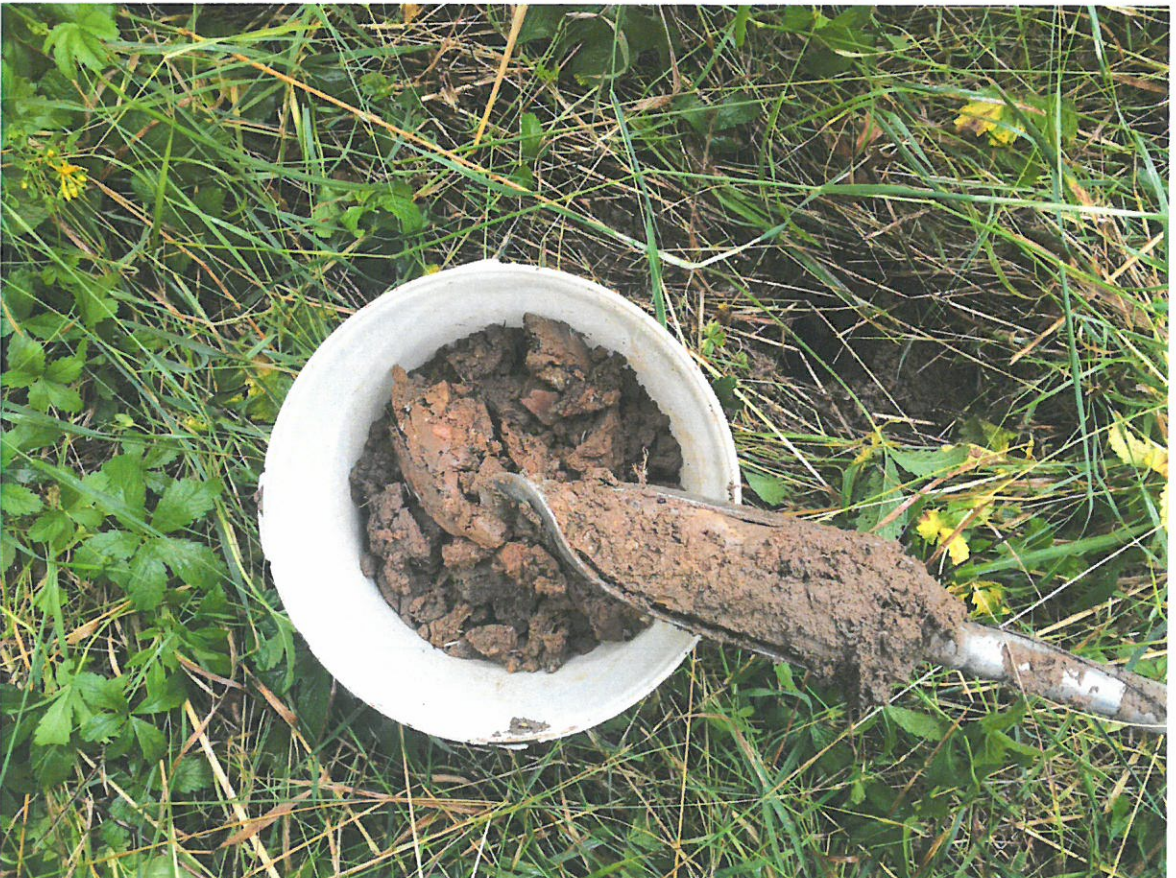
Bilder 13 und 14: Einzelproben (Auszug) der am 01.07.2021 mittels Edelman-Bohrer entnommenen Bodenmischprobe MP4 A (HB)
